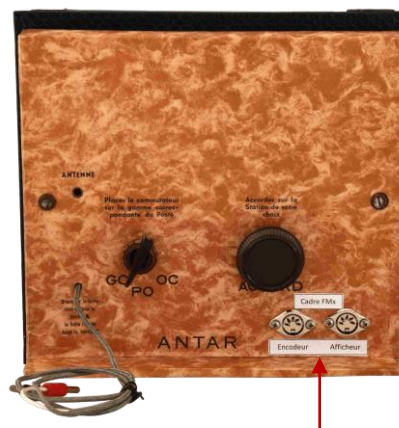
Raccordement de l'afficheur digital et de l'encodeur rotatif au FMx (ici deux embases DIN 5 broches)
